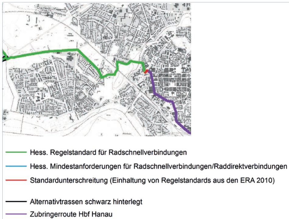
Bild 8-24: Übersicht zur Zielerreichung nach den hessischen Standards zu Radschnellverbindungen (Entwurfssfassung 09/2017) in Hanau
